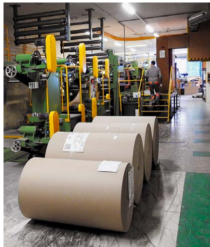
Aus Rollen werden Papierbogen geschnitten.
